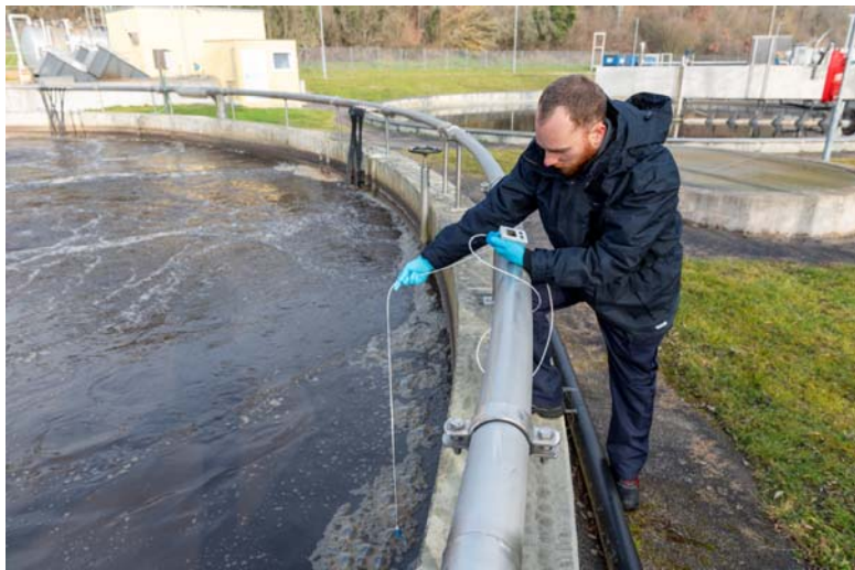
Bild 4 Gelegentliche Messung an Prozesspunkten ohne installierte Online-Messung
